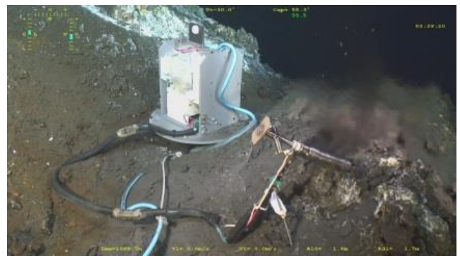
Le module de colonisation CISICS permet également le suivi de la température et le prélèvement de fluides.
