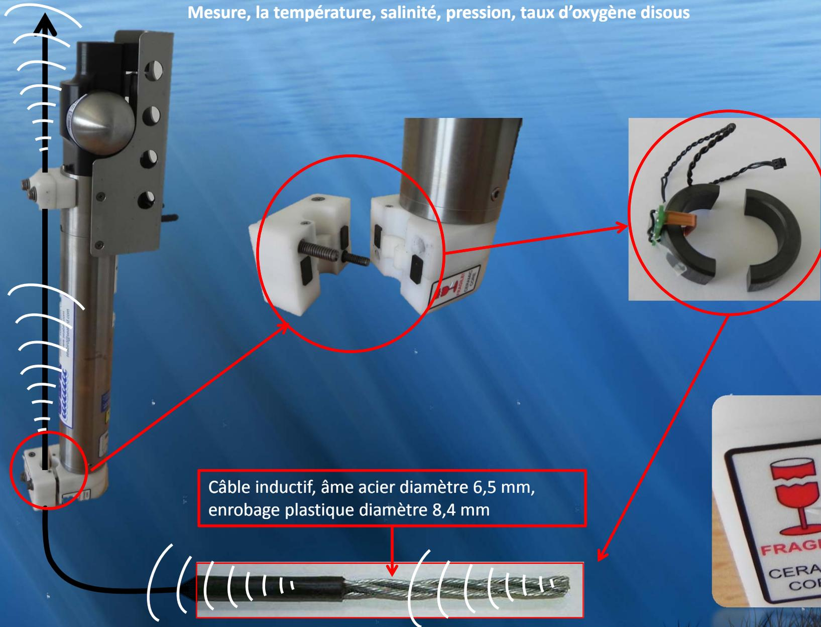
Câble inductif, âme acier diamètre 6,5 mm,
