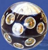
Les capteurs de lumière Tcherenkov sont des sphères étanches équipées de 31 photomultiplicateurs.
