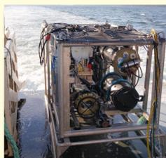
Le profileur pélagique permet d'effectuer des profils et des prélèvements dans la colonne d'eau. Il est équipé d'une CTD Sea-Bird, de capteurs optiques (fluorimètre, granulomètre Laser, Vidéo-Fluo-Analyseur) pour la caractérisation du matériel particulaire et du nouveau capteur d'acide domoïque *in situ*.
