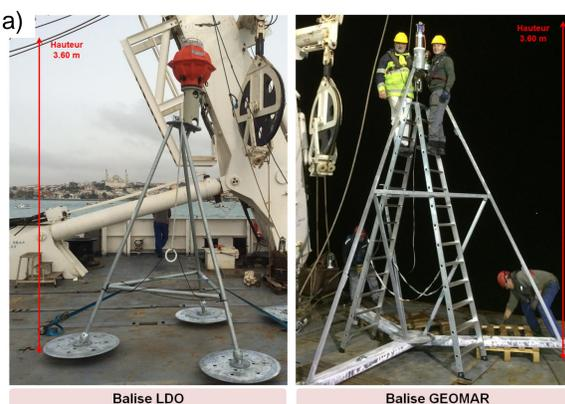
Figure 4. (a) Balises de distancimétrie acoustique de l'expérience MARSITE, en préparation sur le pont du NO Pourquoi Pas. Les supports ont été conçus de manière à s'affranchir de l'effet de la topographie des fonds sur la propagation acoustique. (b) Exemple de synthèse d'une simulation de propagation acoustique entre balises, pour la définition de la géométrie du réseau et de la hauteur des supports.
