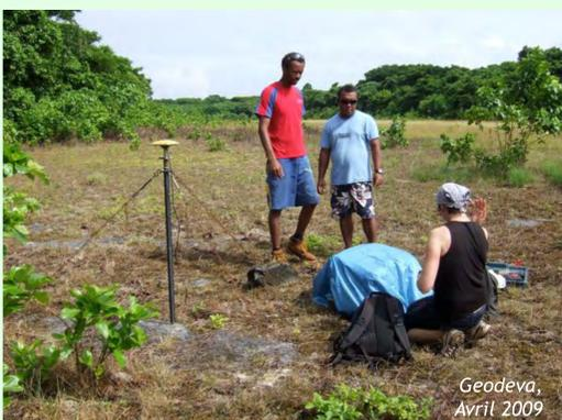
En avril 2009, nous avons remesuré 2 points du réseau au nord de l'archipel, aux Banks et aux Torrès (non mesurés depuis 2000). Une forte crise sismique a eu lieu en octobre 2009 (séismes M7.6, M7.8 et M7.4 en 70 minutes): la mesure d'avril 2009 est essentielle.
