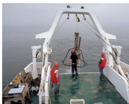
Prélèvements de sédiments par benne.
