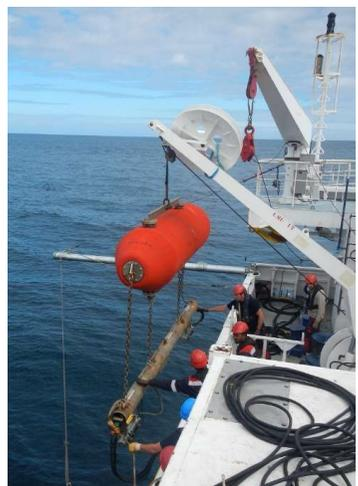
Source sismique HR (1 à 3 mini-GI).
