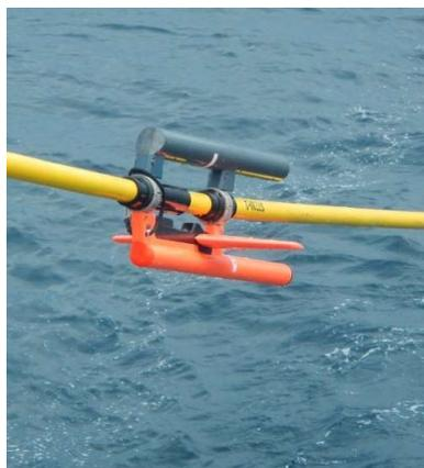
Contrôleur d'immersion sur la flûte sismique.
