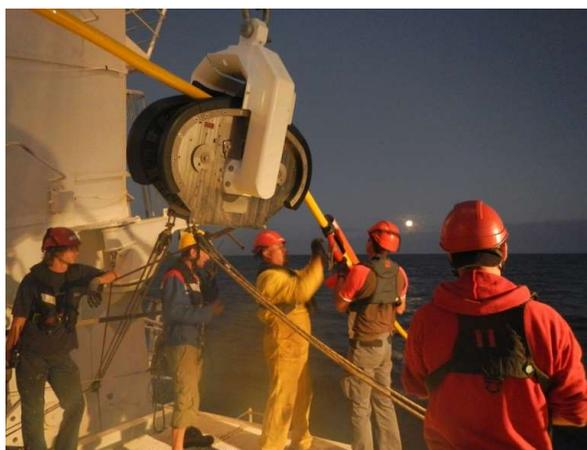
Déploiement de la flûte sismique avec la poulie fairlead.
