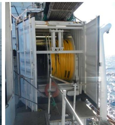
Conteneur avec les sections sismiques de recharge.
