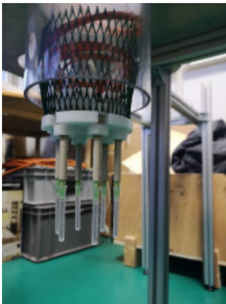
Fig. 3 : Profileur benthique Bathy-prof actuellement développé par le DT INSU, constitué d'une enceinte hyperbare contenant l'électronique et une tête de mesure comportant 6 capteurs
