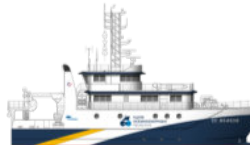
ANTEA Lancement : 1993 Longueur Hors Tout : 24,90 m Maitrise : 11,20 m Tirant d'eau : 5,20 m Déplacement : 420 t
