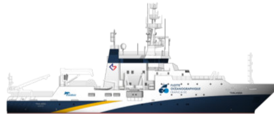
THALASSA Lancement : 1994 Longueur Hors Tout : 27,40 m Maitrise : 14,70 m Tirant d'eau : 6,80 m Déplacement : 520 t
