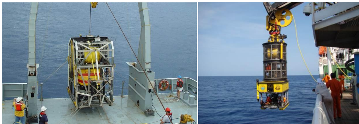
Figure 12 - gauche : déploiement du ROPOS par cage (abandonné depuis 2005) – droite : déploiement du ROSUB par Top-Hat
