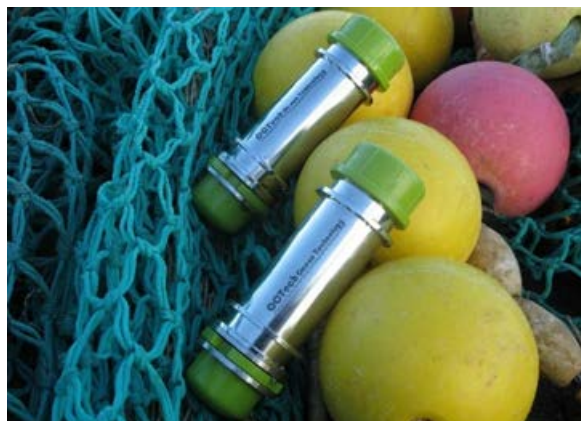
Prototypes de capteurs acoustiques développés et testés par la société OCTech dans le cadre du projet Licado © OCTech
