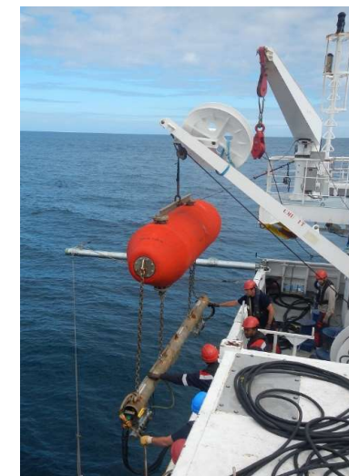
Source sismique HR (1 à 3 mini-GI).
