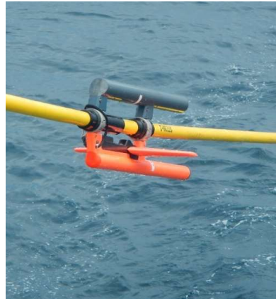
Contrôleur d'immersion sur la flûte sismique.
