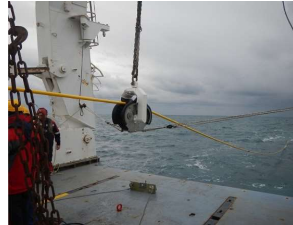
Déploiement de la flûte sismique avec une poulie fairlead.
