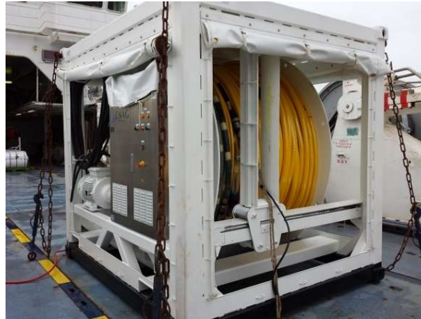
Flûte sismique intégrée sur un touret (conteneur 10').
