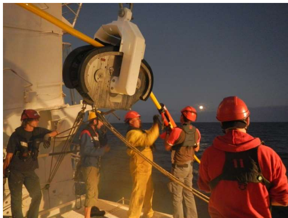
Déploiement de la flûte sismique avec la poulie fairlead.
