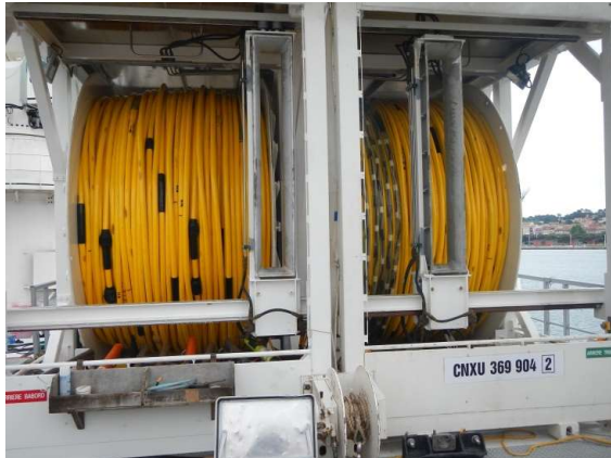
Deux nouveaux tourets avec la flûte sismique de 6000m.
