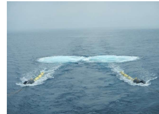
Source sismique durant les acquisitions.
