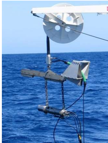
Source sismique SISRAP (GI et déflecteur).
