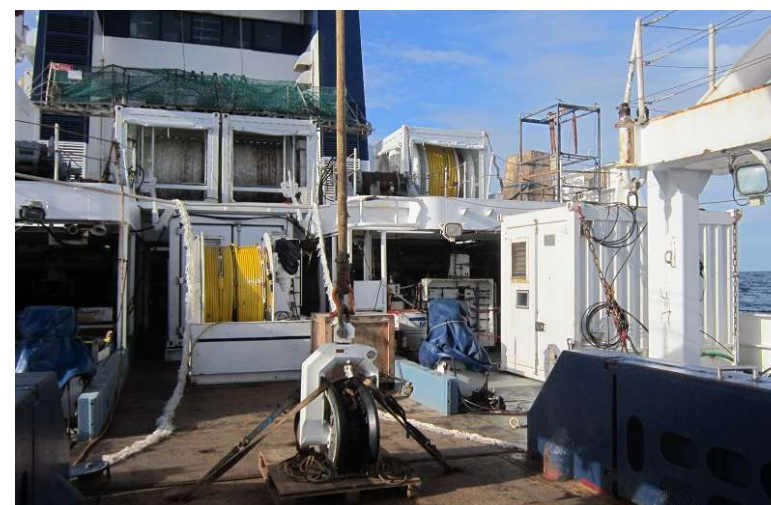
Place arrière du NO Thalassa : tourets pour les flûtes sismiques.
