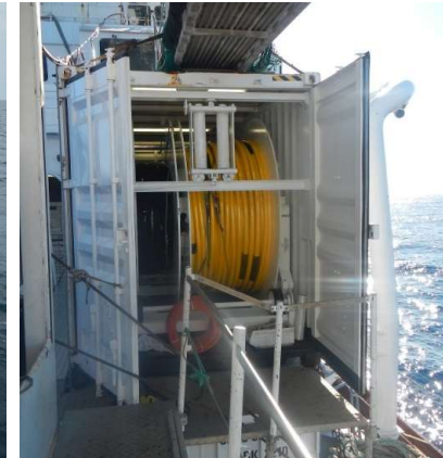
Conteneur avec les sections sismiques de rechange.
