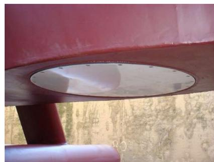
ADCP OS38 du NO L'Atalante (Ø 914 mm, avant/après pose de la fenêtre acoustique).
