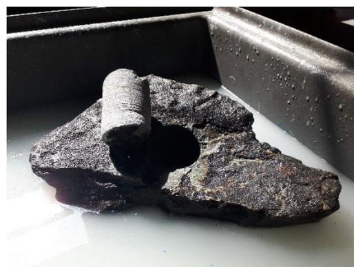
Fig. 1- 3 : Essai en atelier du prototype de carotteuse sur un bloc de basalte qui a permis la réalisation d'une carotte de 10 cm de longueur et de 60 mm de diamètre (avril 2023)
